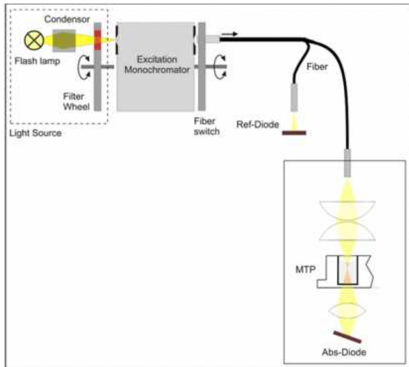
Optical System Absorbance Infinite M200 PRO
